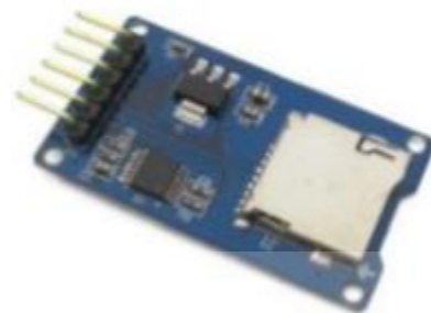
Gambar 2.7 SD Card Module (Sumber: Utomo & Wirawan, 2018)
