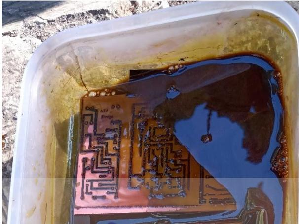
Gambar 4.22 Pelarutan papan PCB dengan larutan  $\text{FeCl}_3$
